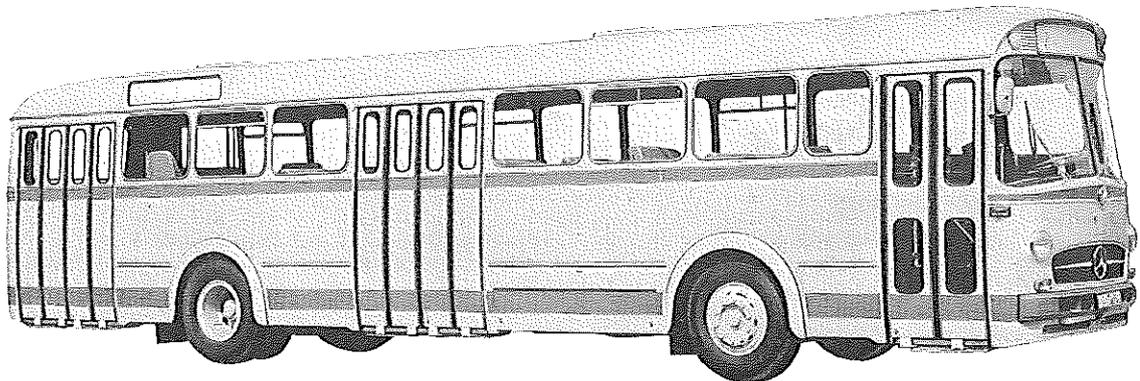
**Diesel-Motor · 6-Zylinder · 4-Takt · 200 PS bei 2200 U/min**
