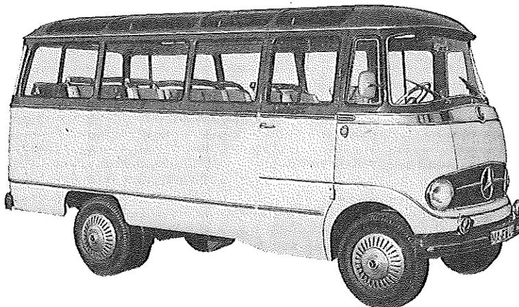
**Diesel-Motor · 4 Zylinder · 4-Takt · 50 PS bei 4000 U/min**
