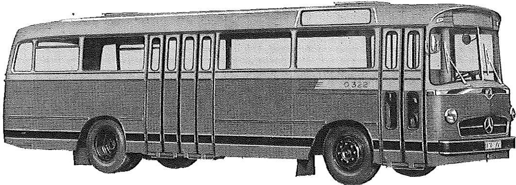
Diesel-Motor · 6 Zylinder · 4-Takt · 110 PS bei 3000 U/min
